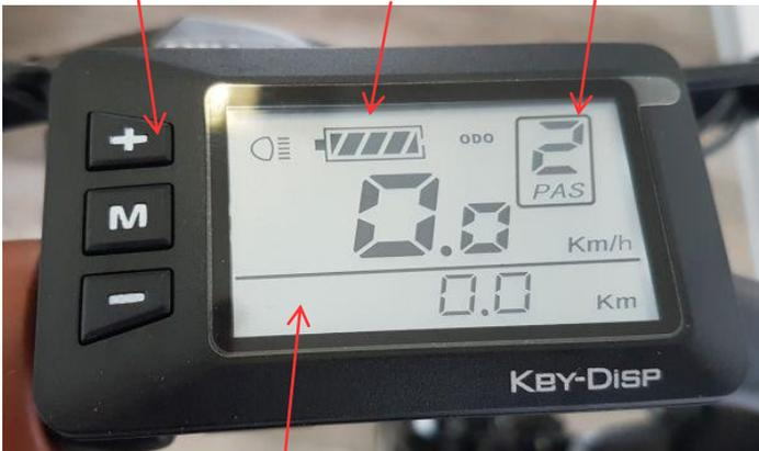
Verschiedene Anzeigen für Kilometer, Geschwindigkeit, etc.
