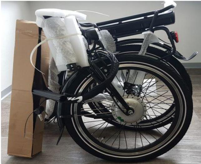
2. Nachdem die Verpackungsmaterialien entfernt wurden, können Sie das Fahrrad aufklappen. In der Mitte des Rahmens finden Sie den Schnellspanner und den Sicherheitshaken.
