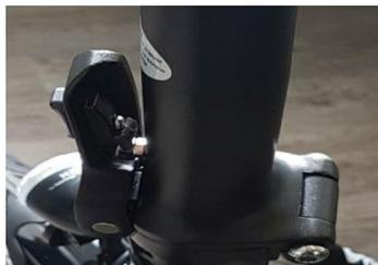
5. Der Lenker kann nun in das Rohr eingesteckt und mit dem Schnellspanner befestigt werden.
