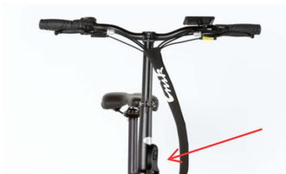
2. Nun lösen Sie den Schnellspanner vom Sattelrohr und stellen den Sattel auf die niedrigste Stufe.
